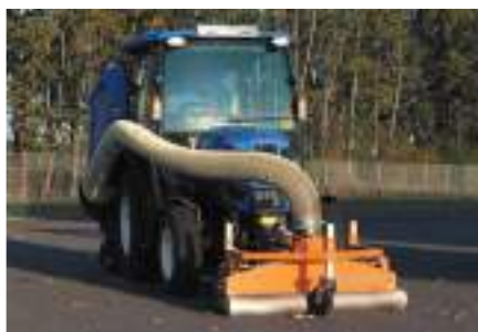
bema Suge-Feiedyse uten hakksliver for eksisterende sugecontainere
