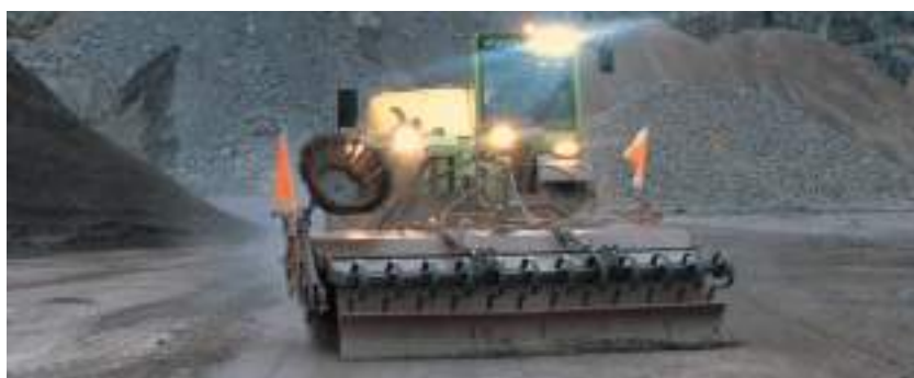
bema 75 Dual PowerMaster med bema skrapeutstyr og høytrykksspylingssystem
