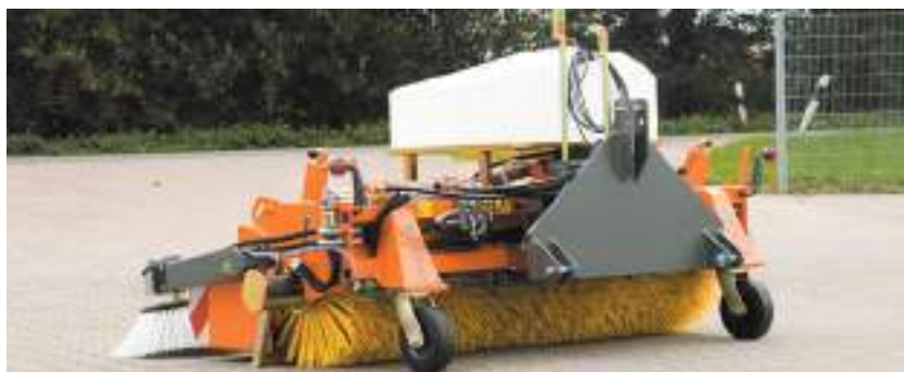
bema 30 Dual PowerMaster med helt utstyr, montering laster-front (trepunkt)
