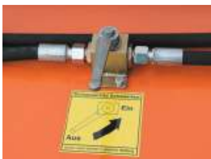
Stengeventil til låsing av snøskilt som er oppbrettet
