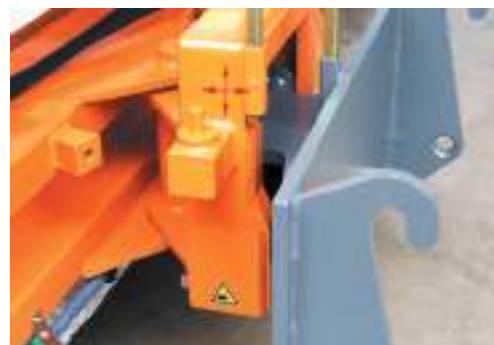
3D-rullenivåkompensasjon til optimal tilpasning til bakken
