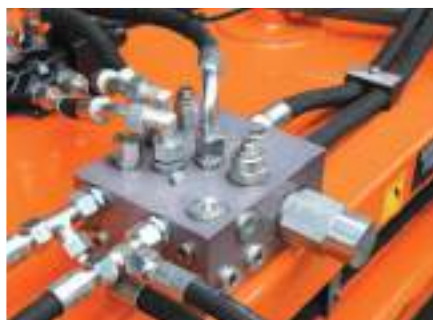
Premium hydroblokken kombinerer alle aggregater
