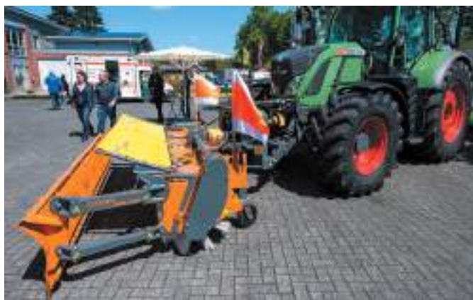
bema Snow-Combi på traktor med valgfritt snøstøvbeskyttelse
