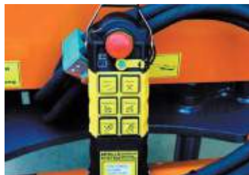
bema Control - kontrollenhet inkludert radio-fjernkontroll
