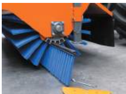
Kassettsystem med børstelementer
