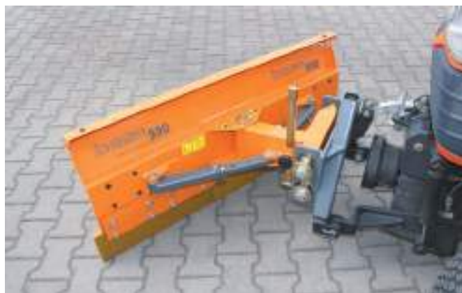
bema Snøskilt serie 550 med mekanisk vinkeljustering
