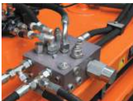
Premium hydroblokk kombinerer alle aggregater
