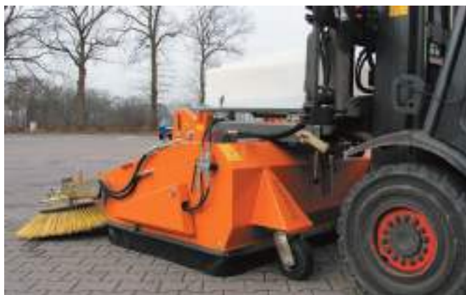
Optimal føring gjennom stabile løpehjul
