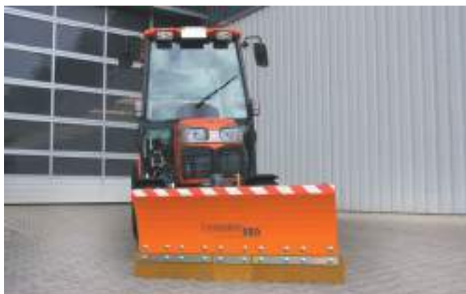
bema Snøskilt serie 550, montering kompakttraktor (trepunktblokk)
