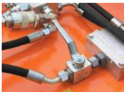
Svingchoke & strømningsdeler jevn løfting av snøskilt
