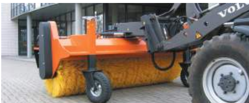
bema Jumbo på hjullaster (hurtigkoblingsmontering med rullenivåkompensasjon)
