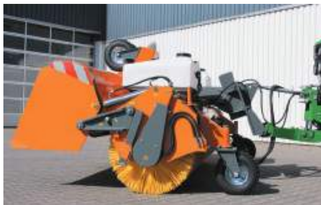
Oppsamlingskar åpent (frifeiing)
