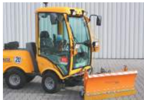
bema Snøskilt serie 550, frontklippermontering
