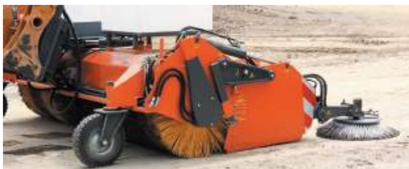
bema Titan Dual på hjullaster med sidefeiekost og vannsprøyteanordning
