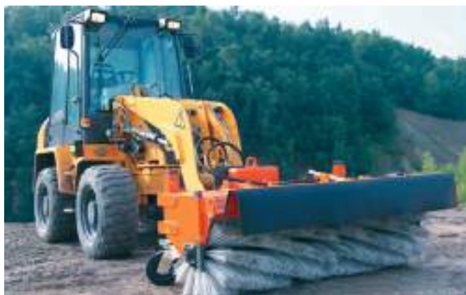
bema 3 Robust - hjullastermontering med sprutbeskyttelse (valgfrritt)
