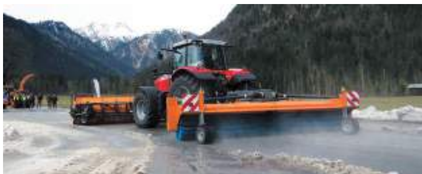
bema Jumbo Airport Turbo overbeviser med arbeidsbredde på 5200 mm
