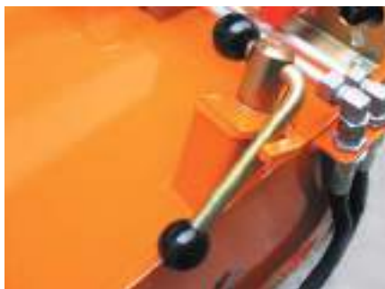
Trinnløs justering av kontaktrykk
