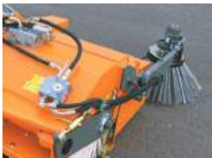
Sidefeiekost flat ståltråd med bema SideControl
