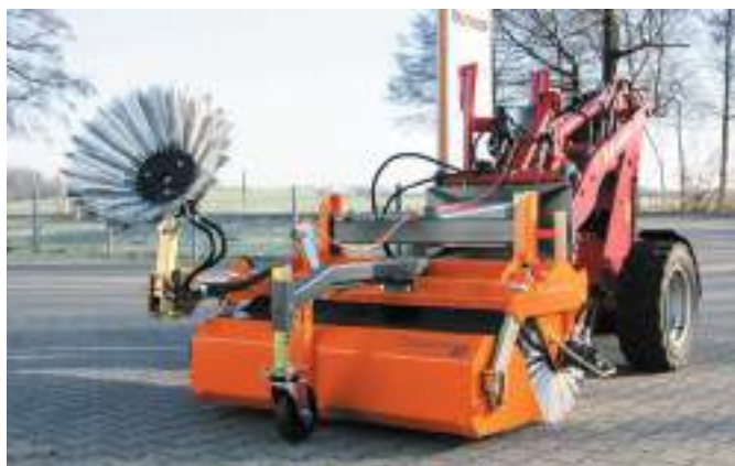
Tømming av oppsamlingskaret via tautrekk (mekanisk), sidefeiekost
