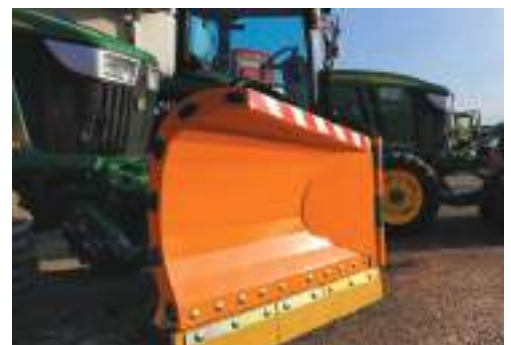
bema V-skilt V800, montering kompaktraktor
