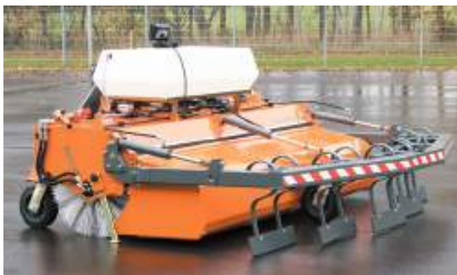
bema 35 Dual PowerMaster med skittoppsamlingskar, bema Skrapeutstyr, kamerasystem med vannsprøyteanordning.
