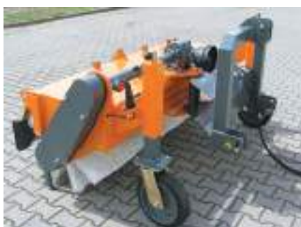
Girkasse og hjul Ø 360 x 85 mm (spesialkonstruksjon)
