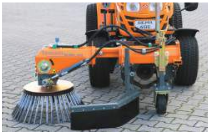
Fleksibel takket være den teleskoperbare sideforskyvningen (300 mm)
