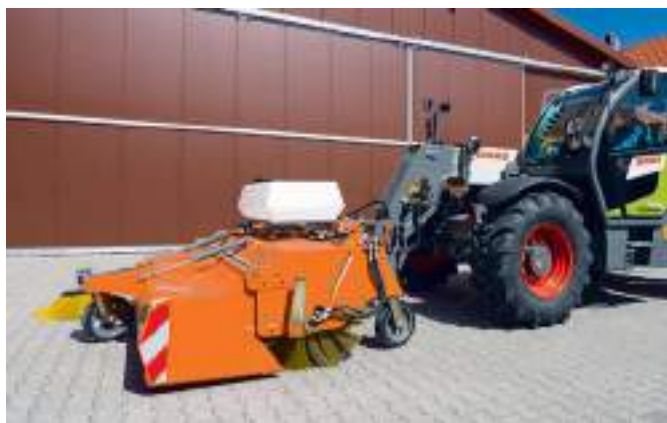
bema 75 Dual PowerMaster på teleskoplaster hurtigkoblingsmontering
