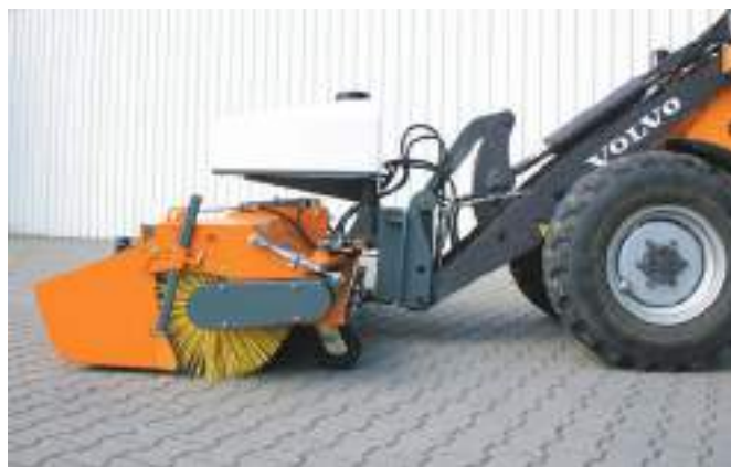
bema Kommunal 600 Dual, hjullastermontering (hurtigkoblingsmontering)
