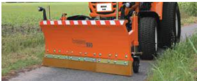
bema Snøskilt serie 550, montering kompaktraktor (trepunktblokk)
