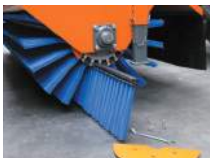
Kassettsystem med børstelementer
