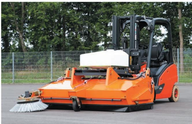
bema 40 Industry mit Seitenkehrbesen und Wassersprühleinrichtung
