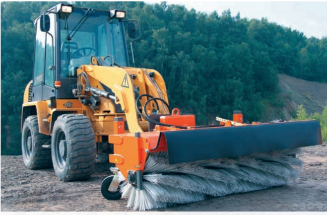
bema 3 Robust - Radladeranbau mit Spritzschutz
