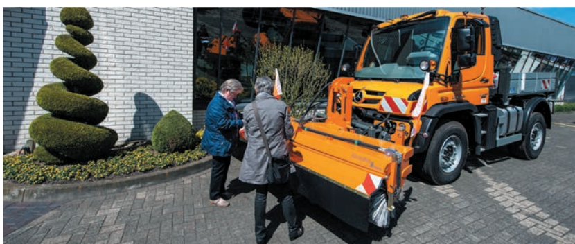
bema 3 Robust - Anbau Unimog-LKW mit hydraulischer Seitenverschiebung
