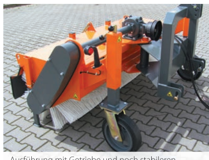
Ausführung mit Getriebe und noch stabileren Laufwädhern Ø 360 x 85 mm (Sonderbau)
