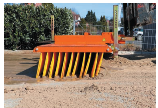
Der Schiebesbesen überzeugt mit 11 Borstenreihen
